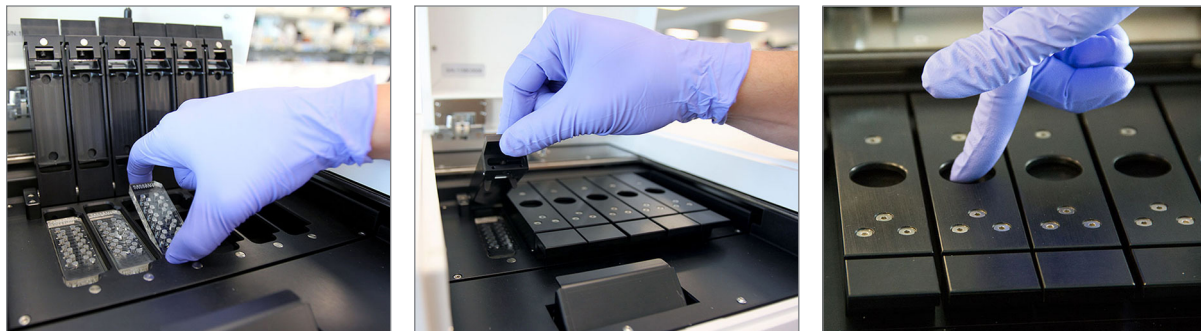
FIGURA 6.4: coloque los cartuchos con el código de barras orientado hacia el usuario al introducirlos en el analizador digital. Cierre los clips magnéticos y asegúrese de presionar la placa metálica que está encima del cartucho después de cerrar la tapa para garantizar que el cartucho esté colocado horizontalmente.
