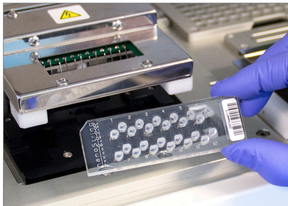
FIGURA 5.18: introduzca un cartucho sin utilizar en la estación de preparación en la dirección indicada
